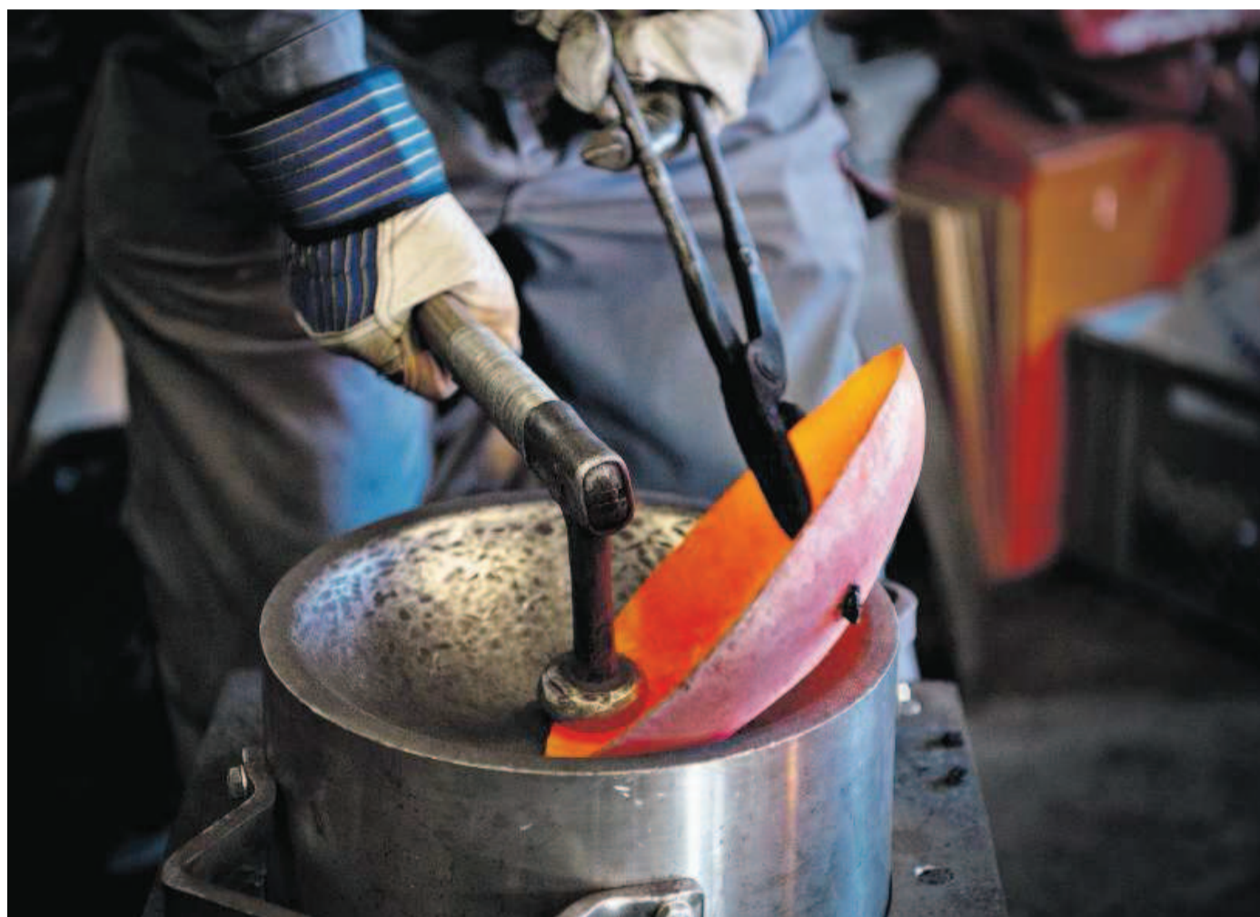
Hämmern, hämmern und immer wieder hämmern macht die erhitzte Stahlplatte zur Klangschale.
